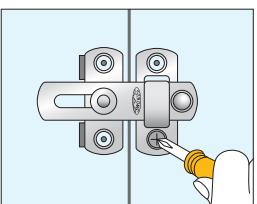
●取付け方法は、ストロング掛金と同様で、両面テープを用いることにより、スムーズに取付けることができます。
